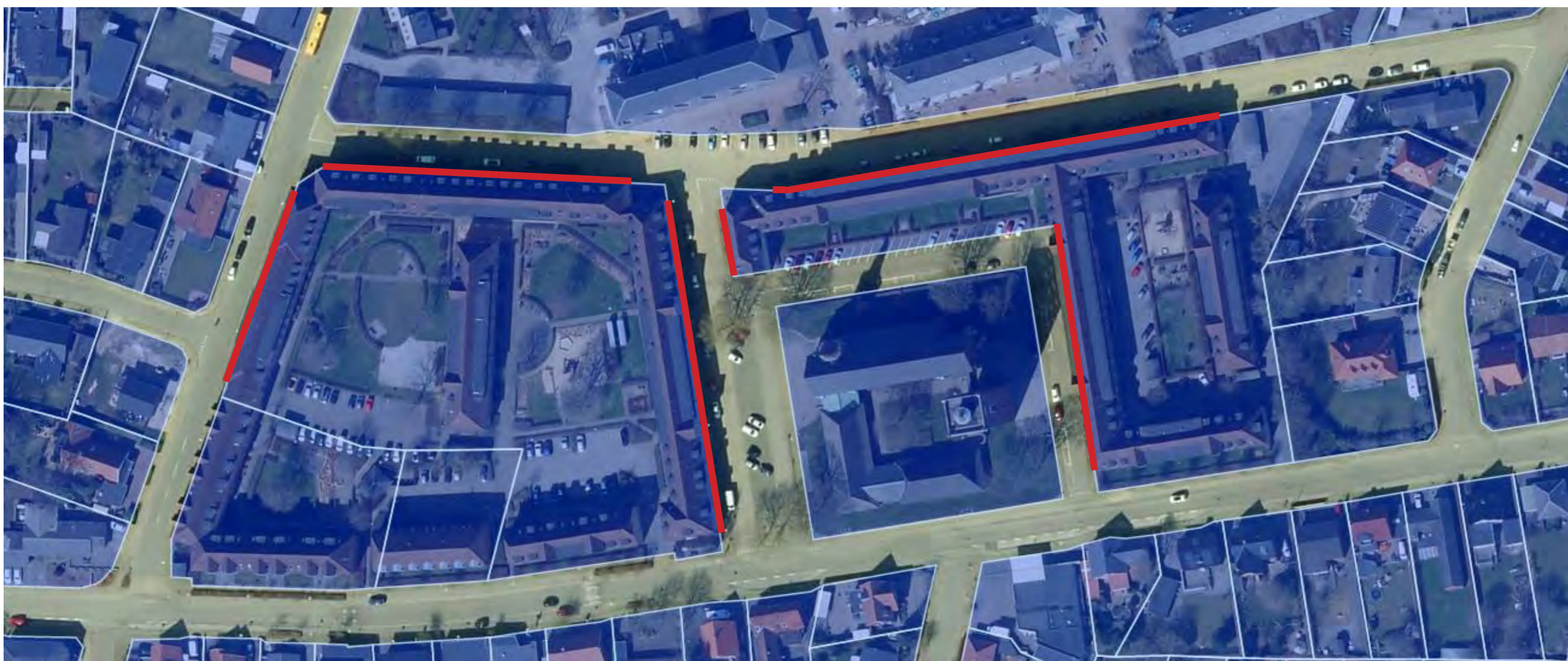
PLACERINGER HVOR EFTERISOLERING GÅR UD OVER SKEL
